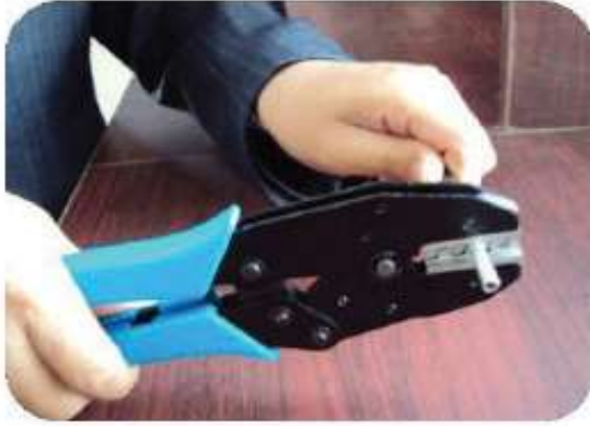
चित्र 8.3.5 क्रिम्पिंग टूल इस्तेमाल करते हुए केबल को छीलना
