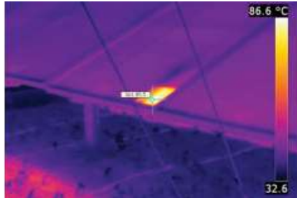
चित्र 9.3.1 कहीं-कहीं छाया पड़ने से संवेदनशील जगह पैदा होता है और मॉड्यूल को क्षति पहुंच सकती है
